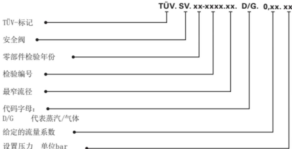
出厂前，所有安全阀通过了抗压强度试验和密封性试验，按客户需求调试好了设置压力并予以铅封。
