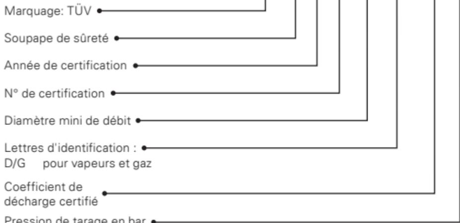
Nos soupapes de sécurité sont contrôlées quant à leur résistance à la pression et à leur étanchéité; elles sont réglées à la pression de tarage souhaitée et dotées d'un plombage.
