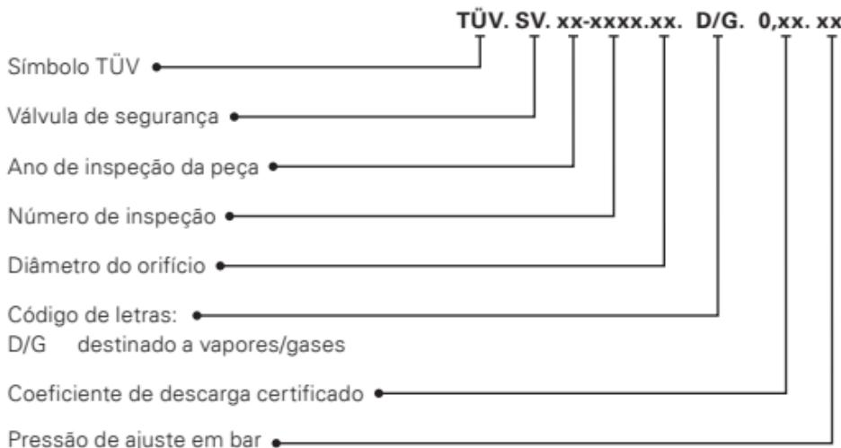
As válvulas de segurança são testadas por nós para resistência à pressão e estanqueidade, ajustadas à pressão de ajuste desejada e vedadas.
